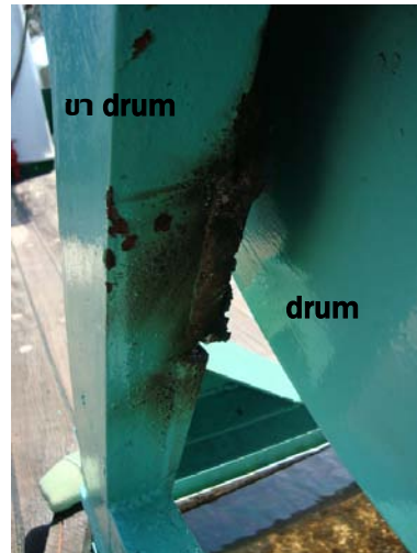
หลังจากใช้ไฟตัดขาบางส่วนออก drum ก็สามารถหมุนต่อไปได้
