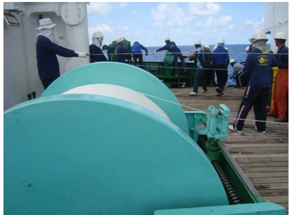
ปึก drum ถูกเบ่งออกจนเหลือช่องว่างน้อยลง
