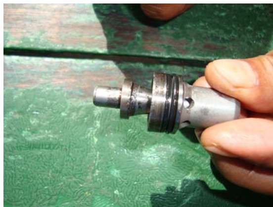
รูปแสดงลิ้นวาล์วควบคุมแรงดันของ shooter ที่แก้ไขจนสามารถเลื่อนเข้าออกได้
